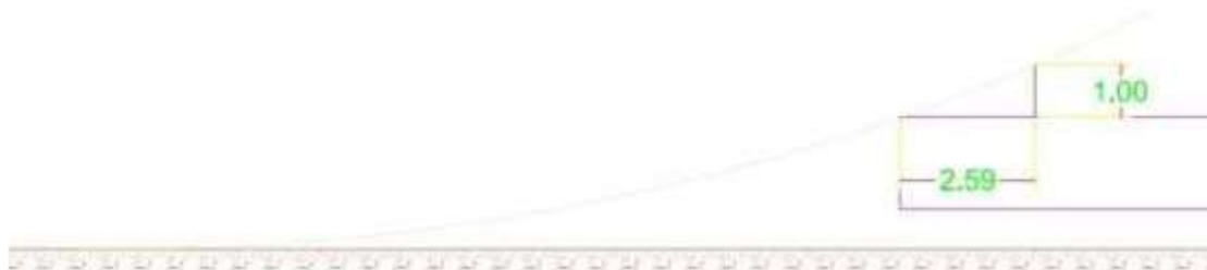
Εικόνα 12. Στα 2,59 μέτρα απόστασης ακίδας από το όριο των Φ/Β πλαίσίων, η κυλιόμενη σφαίρα συναντά τα Φ/Β πλαίσια.
